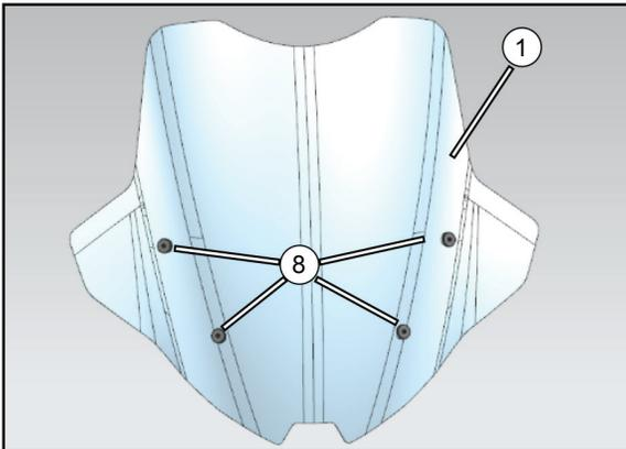
Installez les amortisseurs en caoutchouc (8) dans les trous de montage du pare-brise (1).
