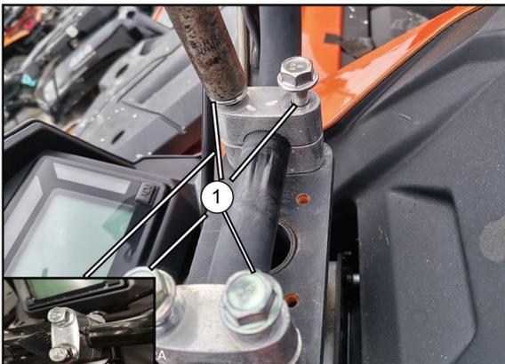
Retirez les boulons de serrage du guidon (1).
