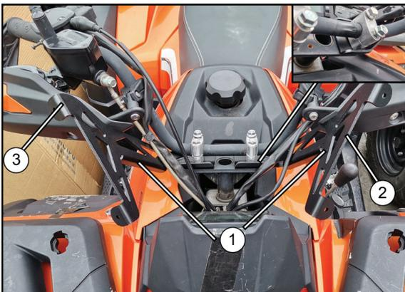
Installez les supports de pare-brise gauche (2) et droit (3) sous les colliers de guidon (1). Réinstallez les boulons et serrez uniformément selon les spécifications.
