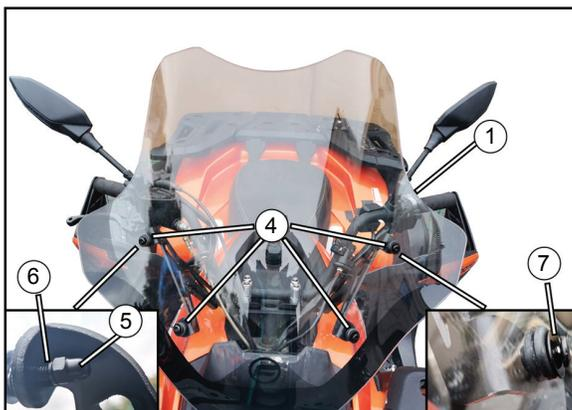
Fixez le pare-brise (1) aux supports à l'aide des vis hexagonales intérieures (4), rondelles 6x20 (7), rondelles (6) et écrous (5). Serrez les fixations selon les spécifications.
