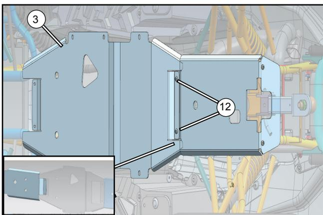
Installez la plaque de protection centrale (3) sur la position avec les vis (12) et serrer à la main.
