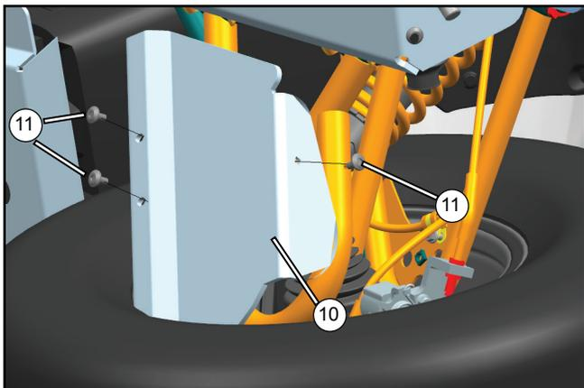
Installez les protections de bras triangulaires arrière (9, 10) sur les bras triangulaires arrière à l'aide de vis (11). Serrez les fixations selon les spécifications.
