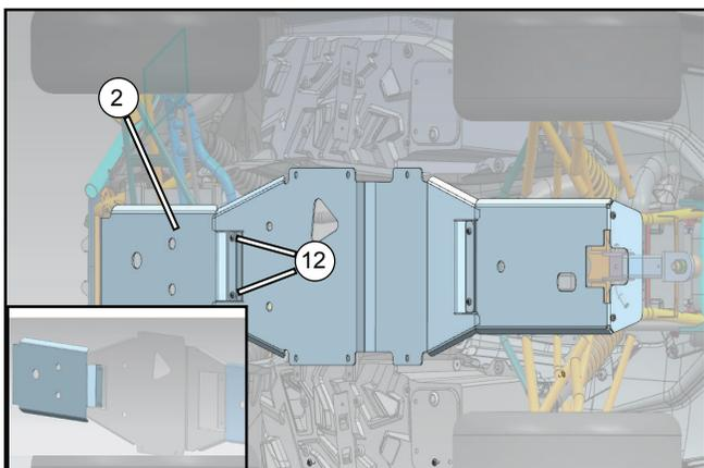
Installez la plaque de protection avant (2) sur la position avec les vis (12) et serrer à la main.
