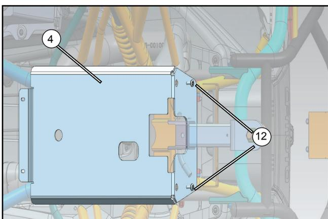
Installez la plaque de protection arrière (4) sur la position au bas du véhicule avec des vis (12) et serrer à la main.
