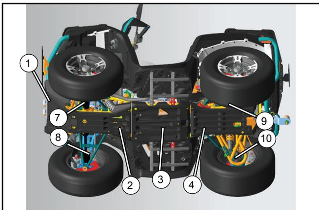
Retirez l'armure de treuil existante (1), gauche et droite, les protections de bras triangulaires avant (7) (8), la plaque de protection avant (2), la plaque de protection du centre (3), la plaque de protection arrière (4) et les protections de bras triangulaires arrière gauche et droit (9) (10).
