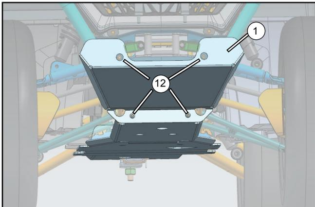
Installez l'armure de treuil (1) sur la position, connectez la plaque de protection avant et serrez-la avec vis (12). Serrez les attaches de l'arrière, du centre, et plaques de protection avant selon les spécifications.
