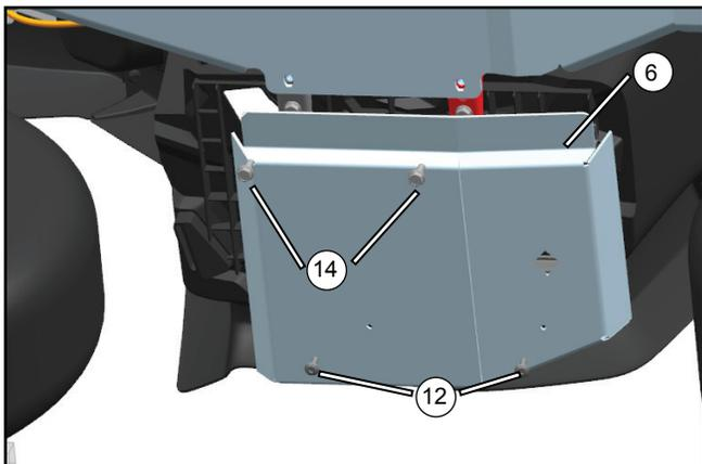
Fixez les plaques de protection gauche et droite (5, 6) sur les côtés la plaque de protection centrale avec les boulons (14), puis installez les vis (12). Serrez les fixations selon les spécifications.
