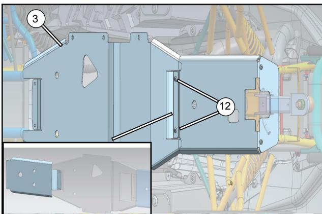
Installez la plaque de protection centrale **(3)** avec les vis **(12)** et serrer à la main.
