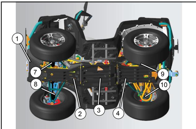
Retirez l'armure de treuil existante **(1)**, gauche et droite, les plaques de protection de bras triangulaires avant **(7) (8)**, la plaque de protection avant **(2)**, la plaque de protection du centre **(3)**, la plaque de protection arrière **(4)**, arrière gauche et droite et les plaques de protections de bras triangulaires **(9) (10)**.
