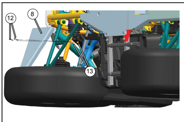
Installez les protections de bras A avant (7, 8) sur les bras A avant à l'aide des vis (12) et des écrous (13). Serrez les fixations selon les spécifications.
