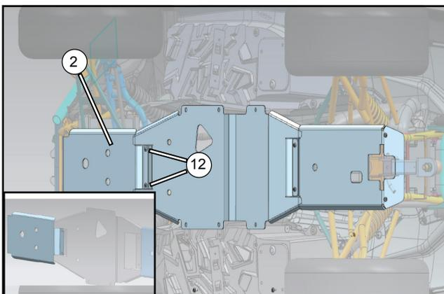
Installez la plaque de protection avant **(2)** avec les vis et serrer à la main.
