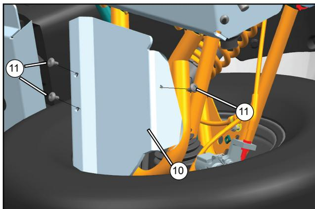
Installez les protections de bras triangulaires arrière (9, 10) aux bras arrière à l'aide de vis (11). Serrez les fixations selon les spécifications.
