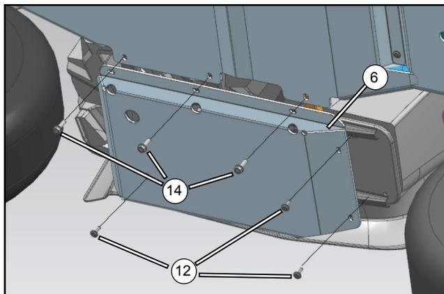
Fixez les plaques de protection gauche et droite (5, 6) sur les côtés de la plaque de protection centrale avec les boulons (14), puis installez les vis (12). Serrez les fixations selon les spécifications.
