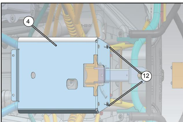
Installez la plaque de protection arrière **(4)** sur la position en bas du véhicule avec des vis **(12)** et serrer à la main.
