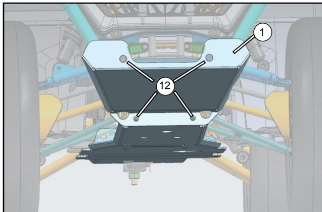
Installez l'armure de treuil (1), connectez la plaque de protection avant et serrez-la avec les vis (12). Serrez les attaches de l'arrière, du centre et les plaques de protection avant selon les spécifications.
