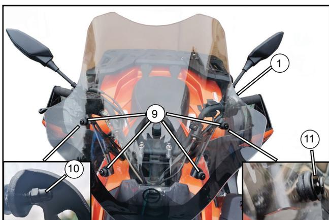
Fixez le pare-brise **(1)** aux supports à l'aide des vis hexagonales intérieures **(9)**, des rondelles 6x20 **(11)** et des écrous **(10)**. Serrez les fixations selon les spécifications. Installer la protection supérieure du guidon
