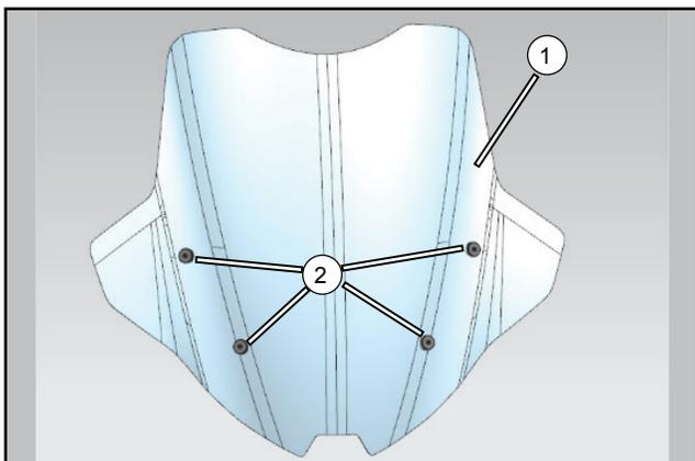
Installez les amortisseurs en caoutchouc (2) dans les trous de montage du pare-brise (1).
