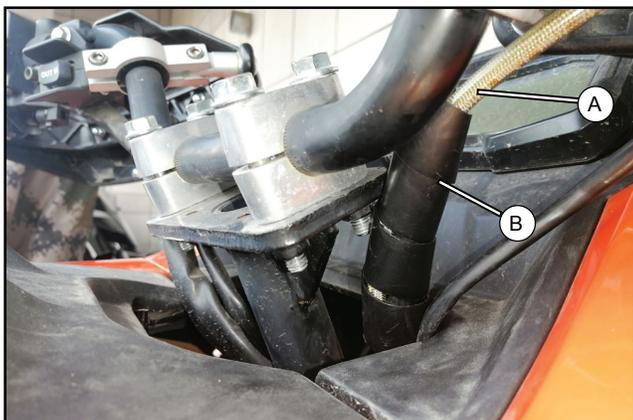
Enroulez le tube de liquide de frein (A) avec le câble protecteur (B).
