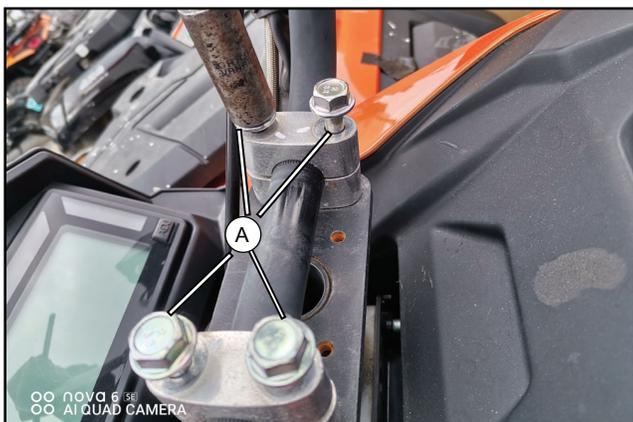
Retirez les boulons de serrage du guidon (A).
