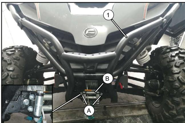
Positionnez l'ensemble pare-chocs **(1)** derrière le câble poulie **(B)** comme illustré. Réinstaller les boulons de poulie de câble **(A)** mais ne les serrez pas pour le moment.
