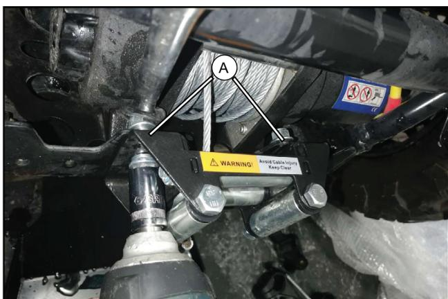
Retirez les boulons de l'ensemble de poulie de câble **(A)**.
