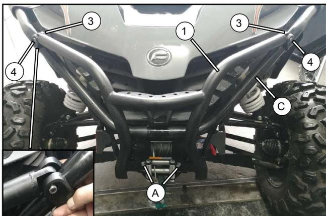
Installez les pinces **(3)** autour du pare-chocs avant du véhicule **(C)**, puis fixez l'ensemble pare-chocs **(1)** avec les vis hexagonales **(4)**. Serrez les boulons de poulie de câble **(A)** et les vis hexagonales internes **(4)** uniformément selon les spécifications.
