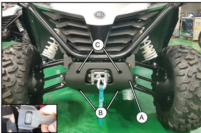
Retirez les boulons **(B)**, **(C)** et la protection de décompression du treuil **(A)**. Ces pièces ne seront pas réutilisées.
