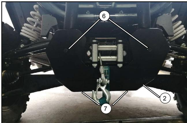
Montez le garde-brosse (2) avec les vis supérieures (6) et les vis inférieures (7).
